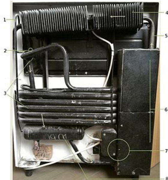
그림 13. 가정용 흡수냉각기의 보기 (출처: Wikipedia, "Absorption refrigerator")
